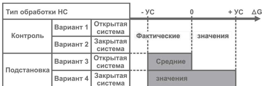
Рисунок 3.23 – Алгоритм работы вычислителя для различных вариантов значений параметра Тип контроля
